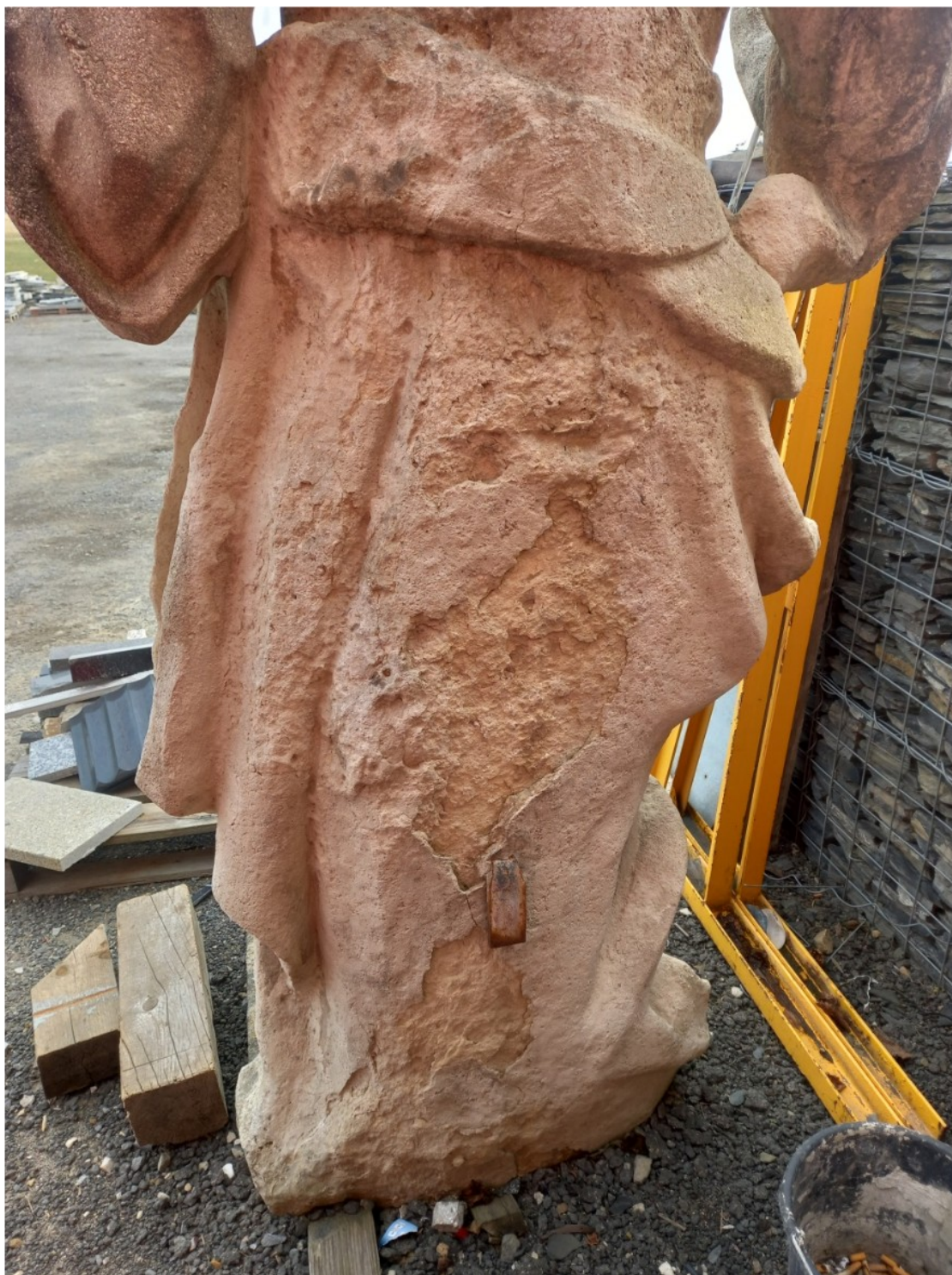
5. Zadní strana figury s hloubkovou degradací originální hmoty kamene.
